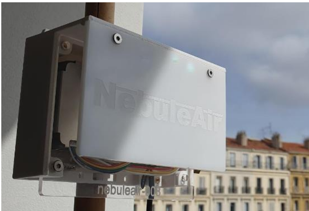
Exemple de capteur de mesure de la qualité de l'air extérieur
