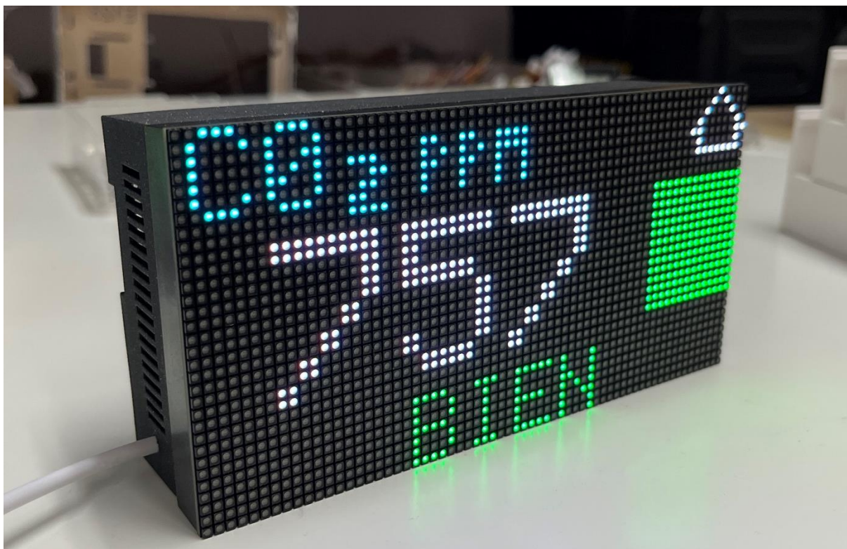
Exemple de capteur de mesure de la qualité de l'air intérieur
